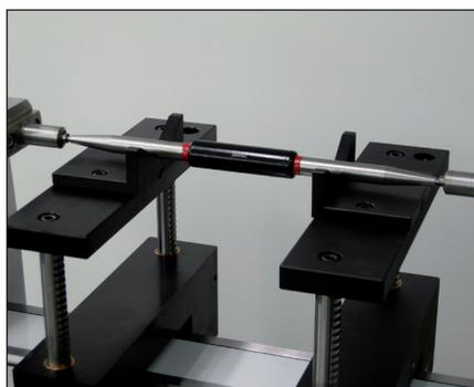
Etalonnage de tiges-étalons
