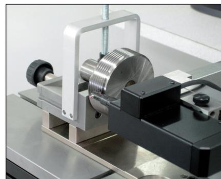
Etalonnage de tampons à filetage
